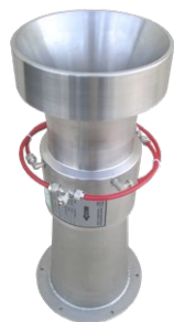
Einlaufventuridüse; Einlauf und Hals aus Vollmaterial gedreht, Auslaufkonus angeschweißt
