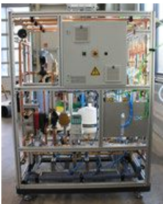
1 Integration des Gaszählers in einen Prüfstand
