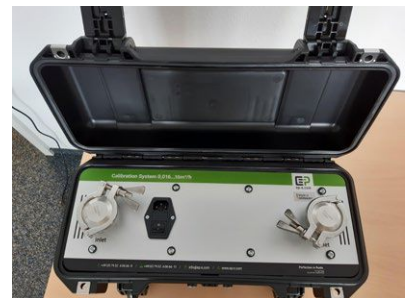
3 Mobile Messbox mit integriertem Gaszähler und Anzeige über Android-App
