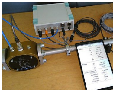
2 Gaszählers mit Messbox und Anzeige über Android-App
